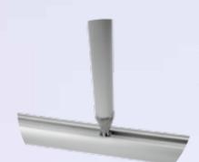
**Verankerung an Profilschiene:** mittels Vierkantmutter auf der ganzen Strecke möglich; für verstellbare Deckenstütze RVS/DS oder mit Deckenhalter RVS/DH. Max. Abstand: 2 m.
