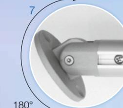
7 **Schräge Wände, spitze Winkel:** der Vario-Wandanschluss RVS/WAV gleicht Asymmetrien bis 180° aus sowie Längendifferenzen bis +/- 5 mm.
